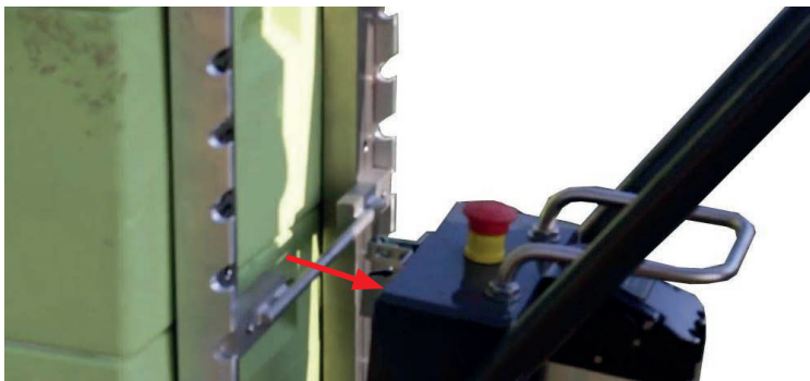
Abb. 57) Obere Traverse von der KraftEx gelöst
