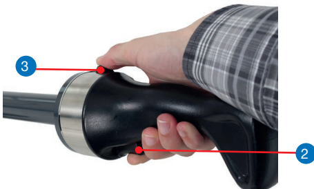
Abb. 39) Rückwärts fahren: GrüneTaste 3 und Stellgeber 2 drücken.
