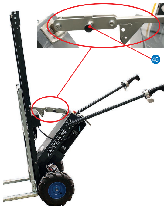
Hubhelfer mit Gabel (Winkelverstellung ausgeklappt)
