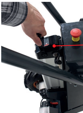
Abb. 43) Akku nach oben ziehen.
