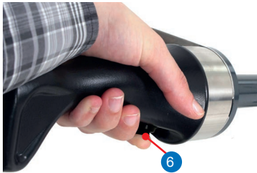
Abb. 38) Zustimmungstaste 6 drücken (am linken Griff).
