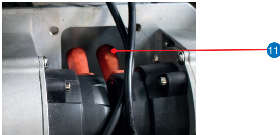
Abb. 30) Hebel heruntergedrückt (Bremsen deaktiviert)
